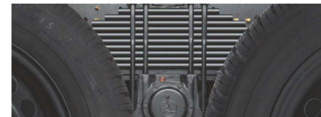
Рессоры 10 мм и 12 мм (спереди и сзади) обеспечивают большую грузоподъемность.
